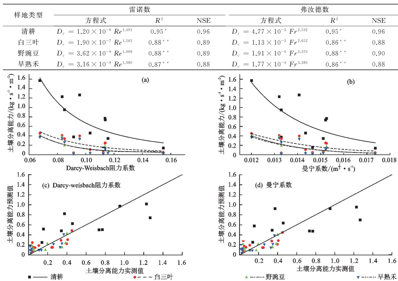
图 6 土壤分离能力与水流阻力的关系
