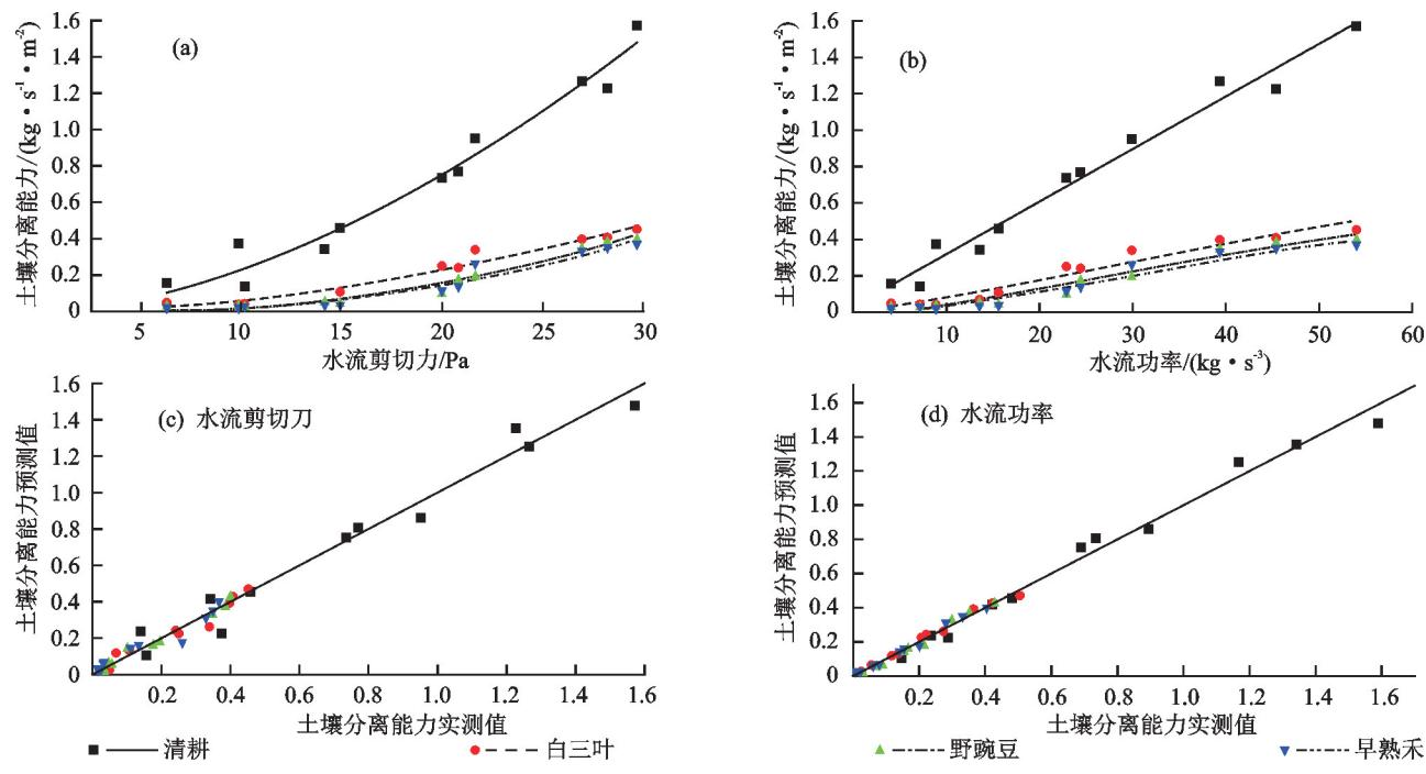
图4 土壤分离能力与水流剪切力及水流功率的关系
