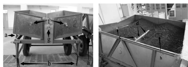
注:a为垄向坡度调节螺旋;b为坡面坡度调节螺旋;c为供水管;d为垄沟内调节水位的排水管;f为上坡位置产流产沙收集口;g为垄面下坡位置产流产沙收集口;h为垄面最低处。
